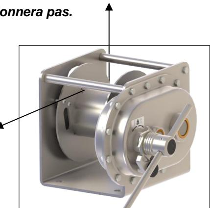
La longueur du câble doit être suffisante pour qu'il reste, lors d'une charge dans la position la plus basse, au moins 3 spires sur le tambour.
