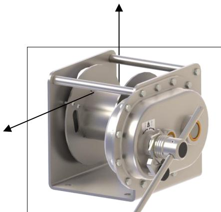
De kabellengte dient zodanig lang te zijn dat bij de last in de onderste positie er minstens 3 windingen op de trommel blijven.
